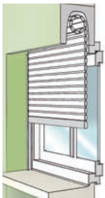
Avec coffre tunnel intégré dans la maçonnerie
