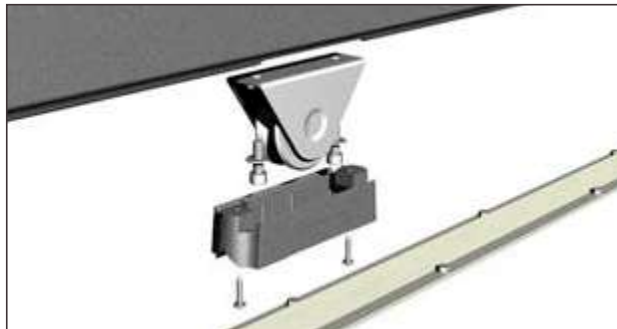
Détail du rail et de l'ensemble roulette et cache-roulette pour coulissant
